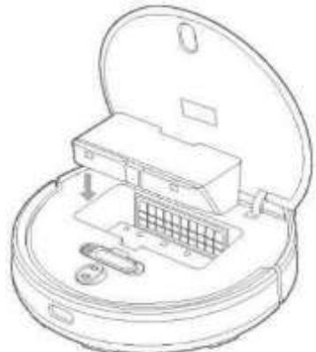
1. Otvorite poklopac robotskog usisavača i umetnite spremnik za prašinu ili spremnik za prašinu 2 u 1 u spremnik za vodu u smjeru prikazanom na slici dok se ne sjedne na svoje mjesto.
