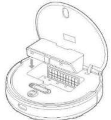
1. Odprite pokrov robotskega sesalnika in vstavite posodo za prah ali 2-v-1 posodo za prah z vodnim rezervoarjem v smeri, kot prikazuje slika, dokler se ne usede na svoje mesto.
